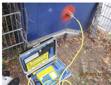
endoskopische Untersuchung Pylonfuß und Dichtheitsprüfung
